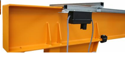
Sterownik nieprzesuwny na żurawiu warsztatowym (sterownik zastępczy)
